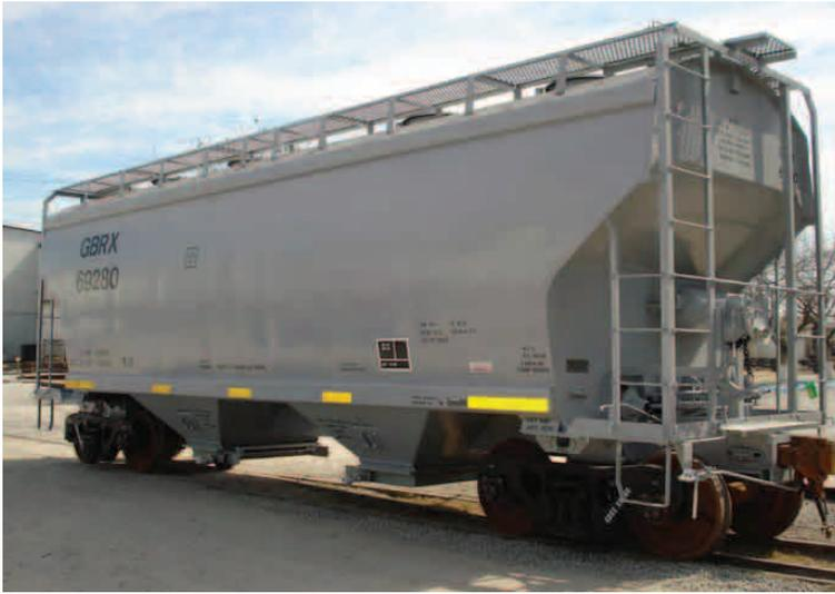
Este carro tolva con cubierta tiene una capacidad de 3250 pies cúbicos; Cuenta con una curva con un diseño bilateral con dos compartimentos y puertas de salida por gravedad diseñados específicamente para el cemento. Opciones para tres o cuatro escotillas en el techo circular están disponibles.
