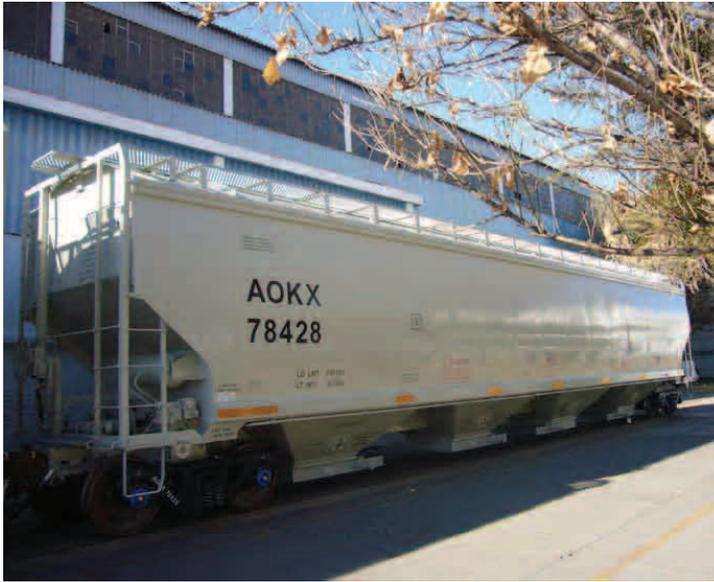
Este diseño de carro tolva con cubierta puede acomodar las necesidades de transporte de granos suaves, específicamente grano seco destilado, un subproducto del proceso de producción de etanol.
